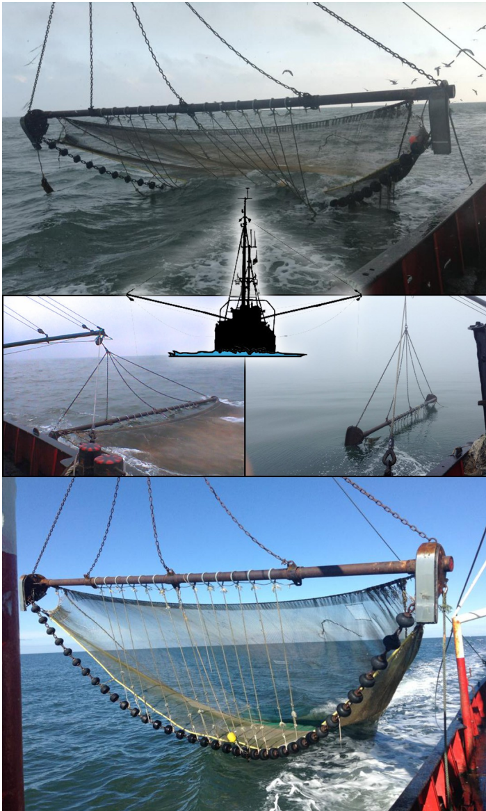
Abbildung: Baumkurre steuerbordseits im Einsatz. Fotos: H.Hoyer
